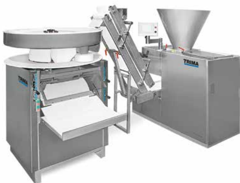
Amasadora redonda y alargada en combinación con la máquina pesadora de masa Metra incluida la cinta de transporte elevada.
