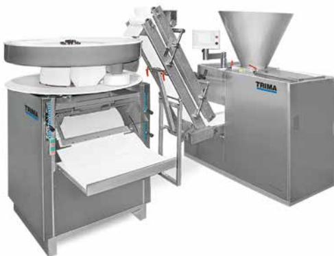
Rund- und Langwirkmaschine in Kombination mit Teigabwieger Metra inklusive Hochförderband.
